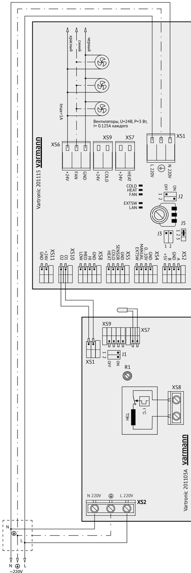
Ручная схема регулирования конвекторов Qtherm Electro позволяет плавно изменять и устанавливать нужную скорость вращения вентиляторов. Скорость устанавливается переменным резистором **R1**. При этом регулирование нагревом ТЭН, осуществляется в автоматическом режиме силовой платой управления ТЭН в зависимости от установленной температуры воздуха переменным резистором **R2**.
