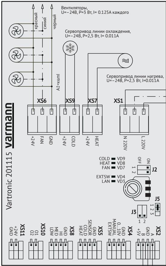
Настенный регулятор Vartronic 703201, 703202 осуществляет регулирование температуры в помещении посредством плавного изменения скорости вращения вентиляторов и управлением термоэлектрическими сервоприводами для изменения расхода теплоносителя через теплообменник конвектора.
