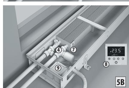
**5B** Схема регулирования комнатным термостатом.
