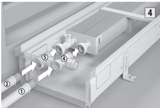
Снимите заглушки с корпуса конвектора, с той стороны, с которой планируется произвести подвод трубопроводов.
