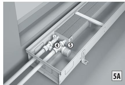
**5A** Схема с ручным регулированием.
