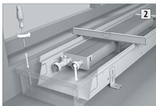
Используя регулировочные винты, по уровнемеру установите корпус конвектора в горизонтальной плоскости в уровень нулевой отметки готового пола.
