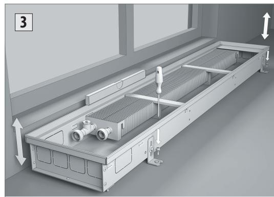
Закрепите винтами ножки для фиксации конвектора в полу. Убедитесь, что конвектор жестко закреплен на поверхности пола.
